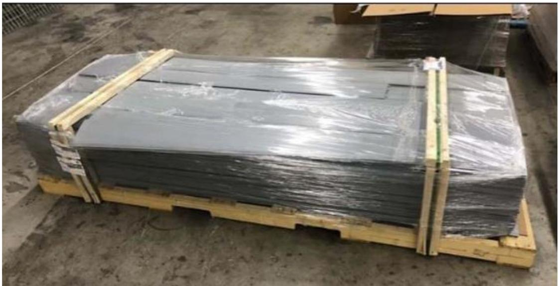
图一. 一个货架上的 Form-A-Tube®可以制作 50 个直径为 46 cm，高 20 cm 的新桩。
